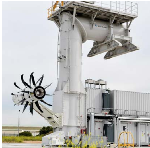
Figure 4 – Premiers essais du prototype d’Open Rotor à Istres en 2017, sur un pylône support de 18 m de haut
