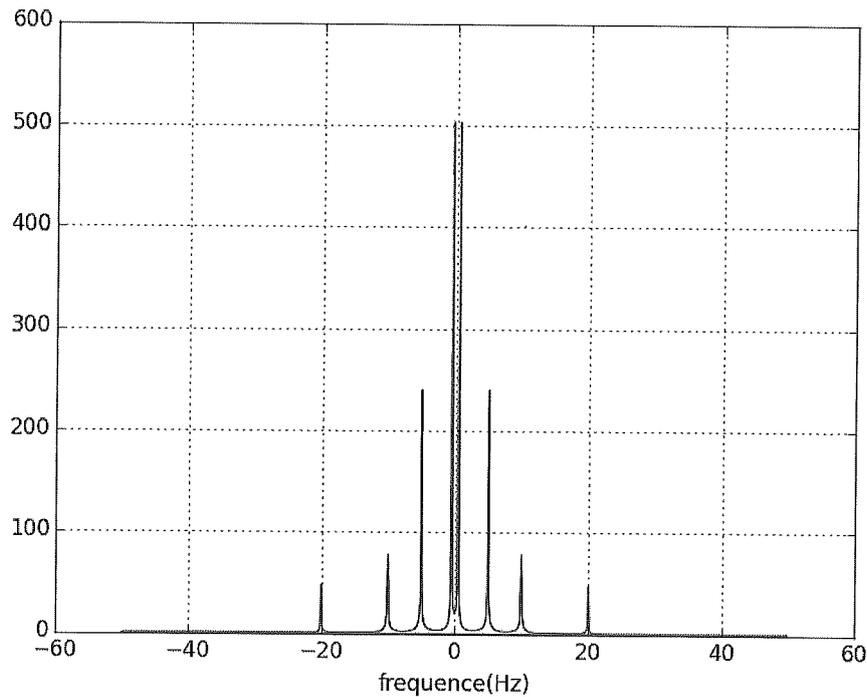
**Figure 5 : Transformée de Fourier de  $x(t)$  éq (3)**
