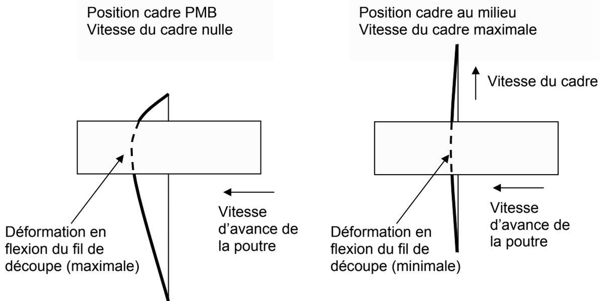
**ANNEXE L** Principe de mise en mouvement de la poutre
