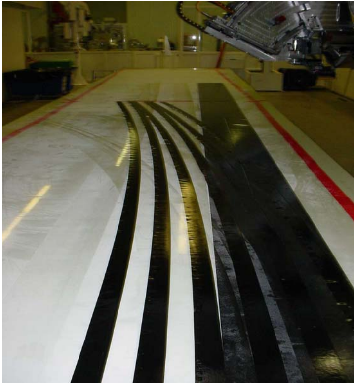
Figure 2.2 : Trajectoire courbe de dépose de bande sur une surface plane (steering)
