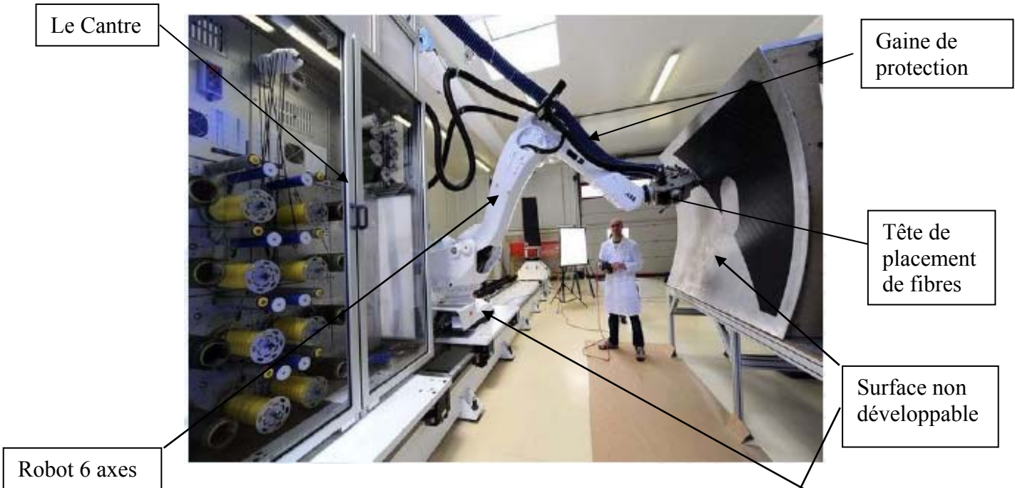
MACHINE DE PLACEMENT DE FIBRES
