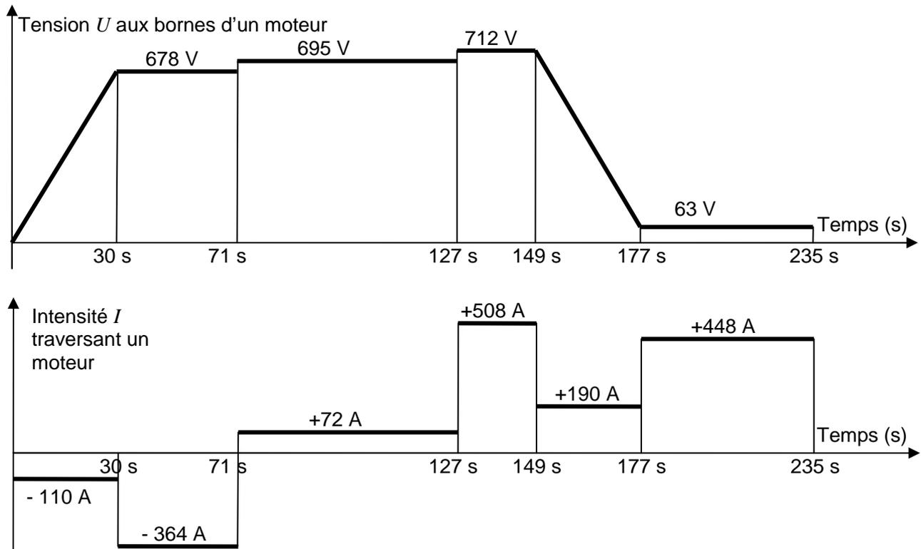
Le Vanoise Express est équipé d'un système de récupération de l'énergie. Lorsque les moteurs doivent freiner le téléphérique, ils fonctionnent en génératrices, et l'énergie électrique qu'ils produisent est réinjectée dans le réseau EDF (avec un rendement que l'on supposera égal à 1).
