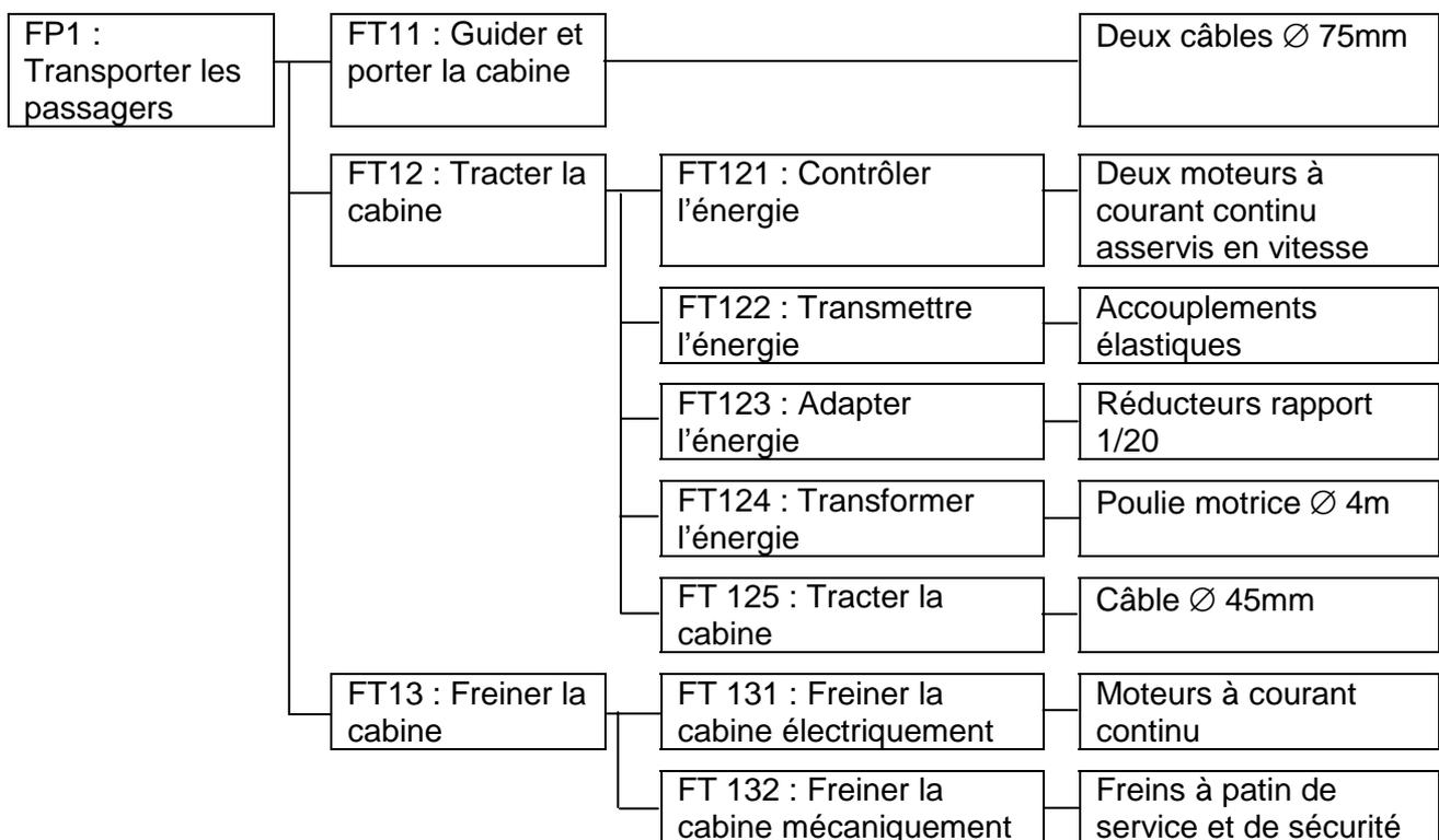
Schéma de la salle des machines limité aux fonctions FT12 et FT13 : Voir annexe 1
