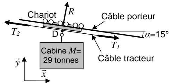
**Question 4. :** Les freins à patin de service agissent des deux côtés de la poulie en E et E' sur un rayon  $r = 1.9$  m. L'action de chaque frein de service sur la poulie sera modélisée par un glisseur. La tension des ressorts est  $T_{ress\ mini}$ . On se place à la limite du glissement.
