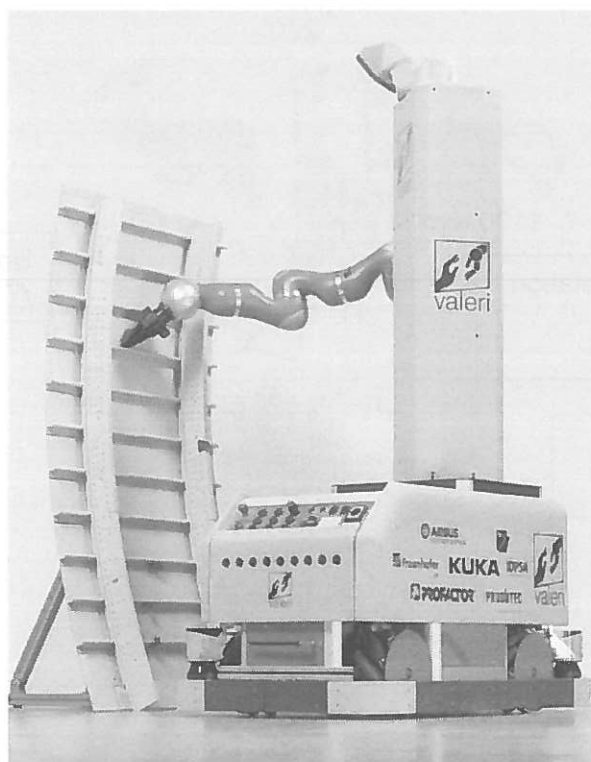
Figure 1 Omnirob, la robotique collaborative au service de l'industrie aéronautique © VALERI
