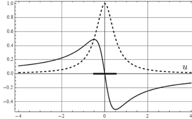
Figure 8 : Parties réelle et imaginaire de l'impédance électrique du quartz au voisinage de la résonance parallèle. Les ordonnées sont normalisées au maximum de la courbe en pointillés, soit à  $3,27 \times 10^8 \Omega = 327 \text{ M}\Omega$ ; en abscisse,  $u = Q \left( \frac{\omega}{\omega_s} - \frac{\omega_p}{\omega_s} \right) = Q(x - a)$ . La longueur réelle du trait épais sur l'axe des abscisses est  $\frac{1}{Q}$ .
