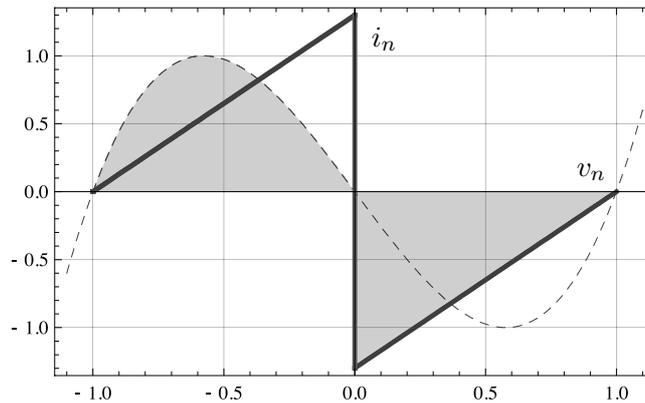
Figure 16 : Modèle simplifié de relation courant-tension. En abscisse, la tension normalisée  $v_n = \left(\frac{g}{\beta}\right)^{1/2} v$ , en ordonnée l'intensité normalisée  $i_n = \frac{3}{2g} \left(\frac{3\beta}{g}\right)^{1/2} i$ . La pente des segments de droite est, dans ce diagramme,  $\frac{3}{4}\sqrt{3}$ , correspondant à  $\frac{g}{2}$  en unités ordinaires.
