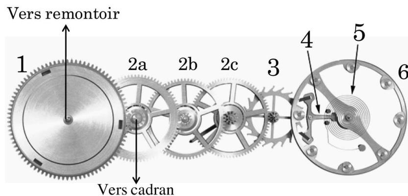
Figure 3 : Éléments d'une montre mécanique :
