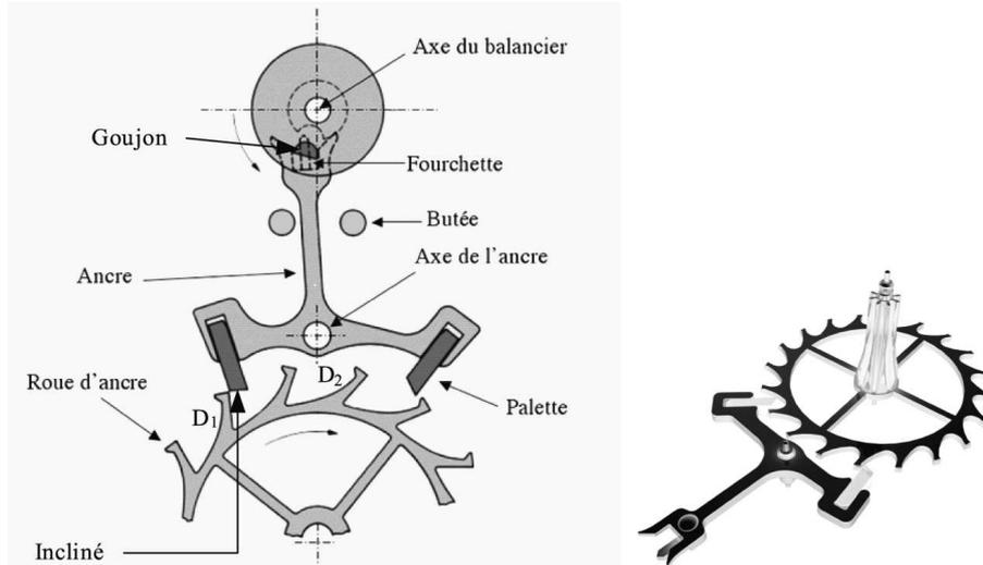
Figure 4 : Vue d'ensemble du système fourchette-ancre-roue d'ancre.
