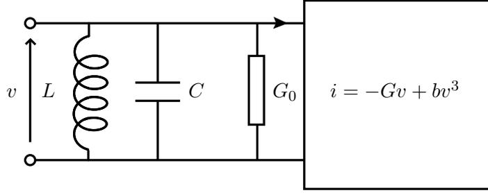
Figure 14 : Entretien d'un oscillateur par conductance négative et non linéarité.
