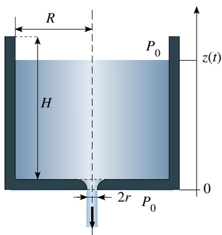
Figure 1 Gauche : Clepsydre grecque reconstituée (fin du V<sup>e</sup> siècle av. J.C.). Droite : Le modèle. L'axe  $z$  est orienté vers le haut. L'orifice a un profil convenable et une longueur adéquate pour que l'accélération due à la surpression se termine à la sortie, où la pression est  $P_0$ .
