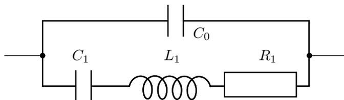
Figure 7 : Schéma électrique équivalent d'un oscillateur à quartz.
