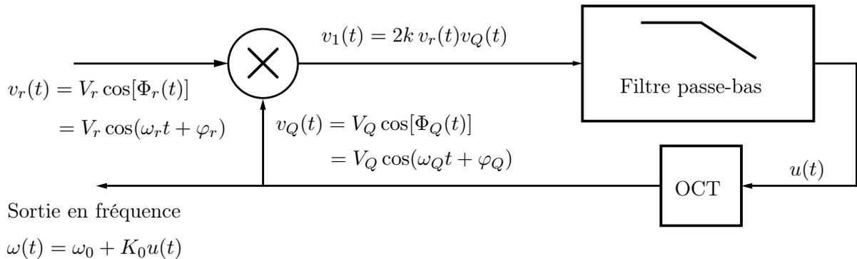
Figure 10 : Boucle à verrouillage de phase.
