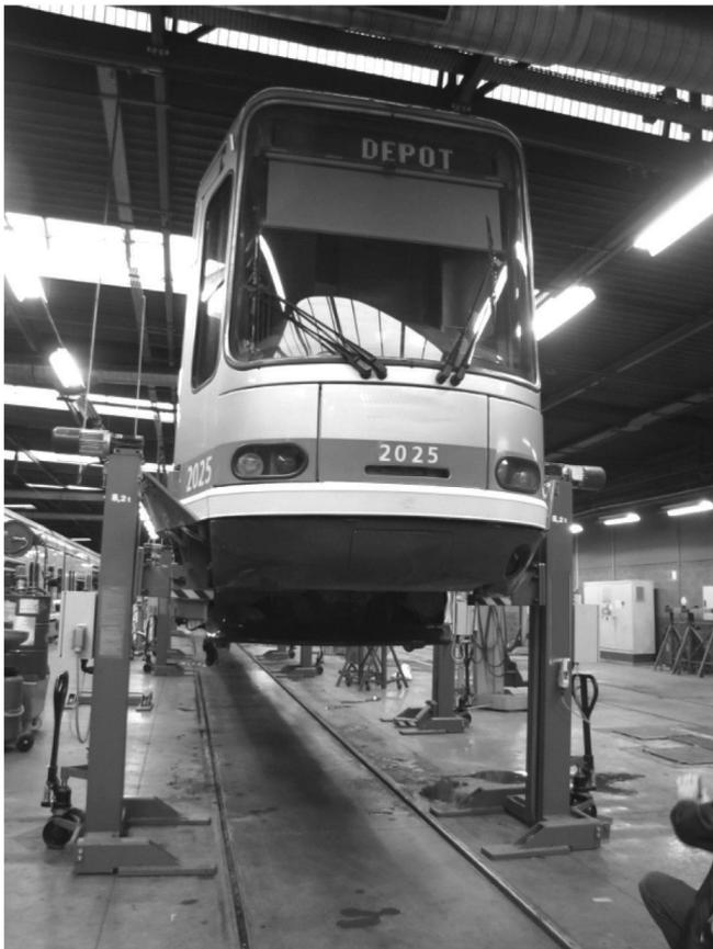
Photo 5 : Tramway en position soulevée
