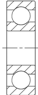
Figure 20 : Roulement à billes à contact radial 63032
