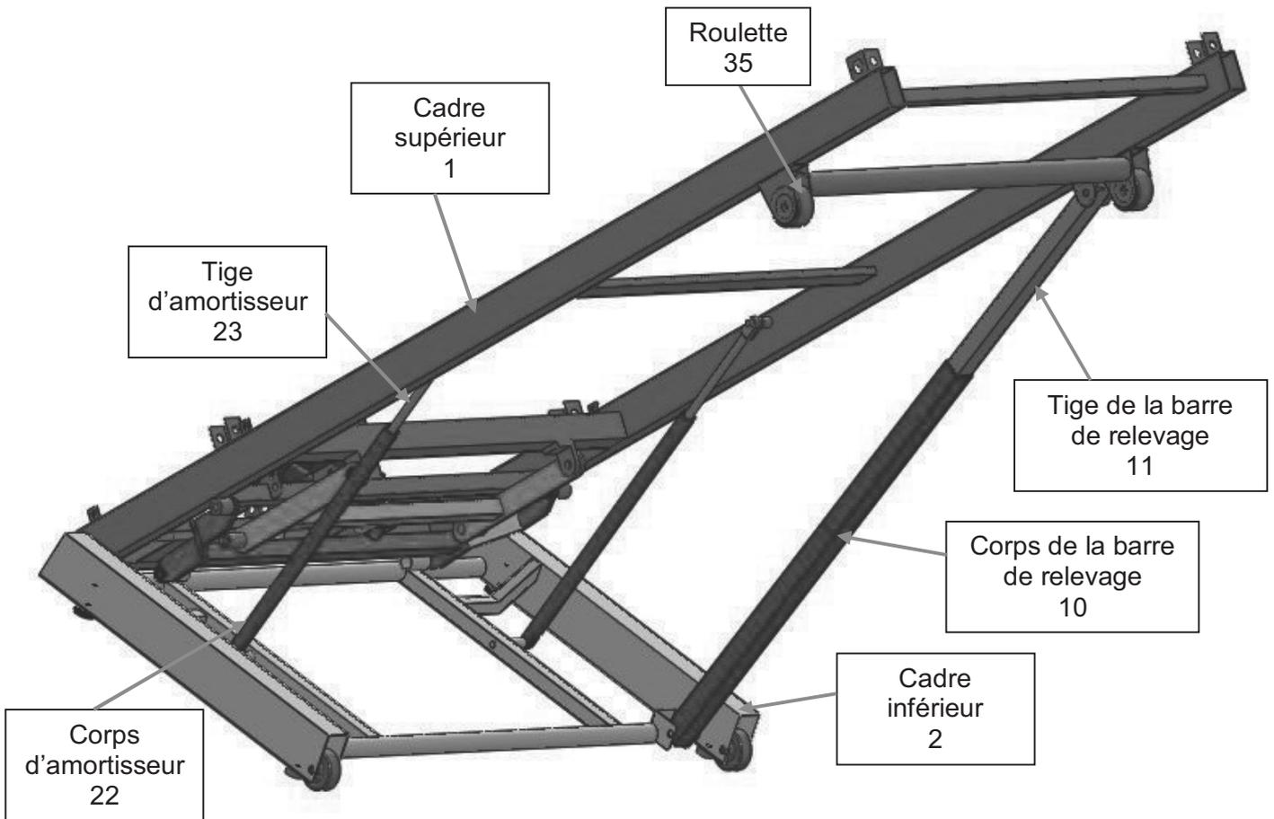
Figure 9 : Vue d'ensemble du dispositif de pliage
