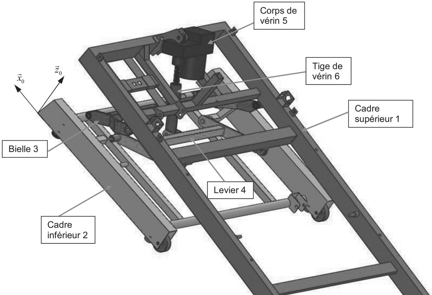
Figure 3 : Vue d'ensemble du dispositif d'inclinaison
