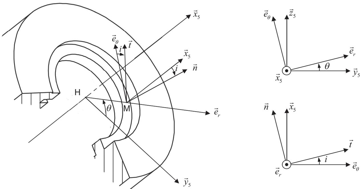
Figure 17 : Figures de calcul associées à l'écrou
