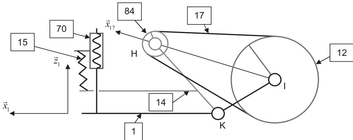
Figure 8 : Schéma de principe du dispositif de tension
