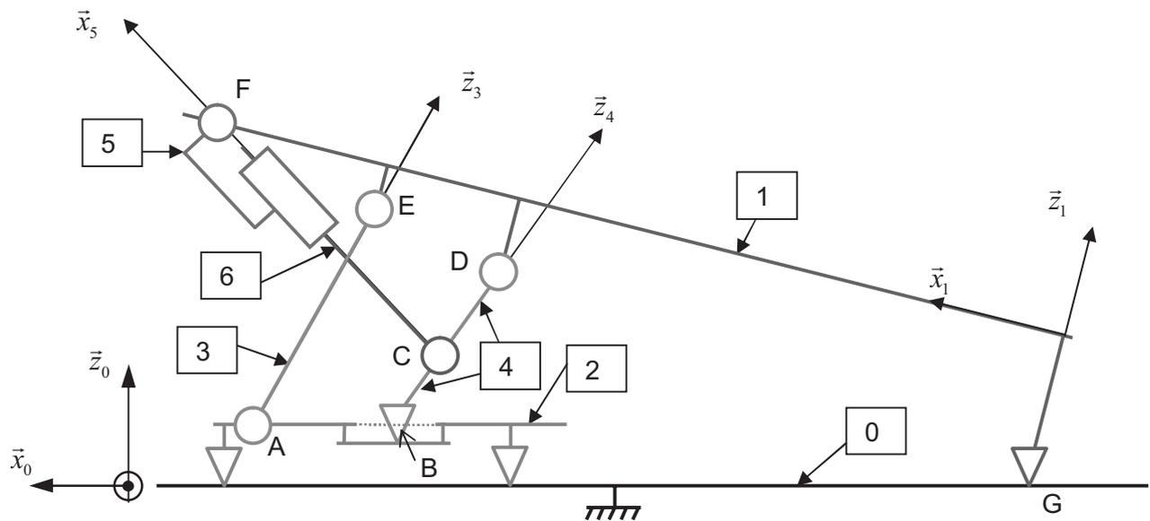
Figure 4 : Schéma cinématique plan du dispositif d'inclinaison
