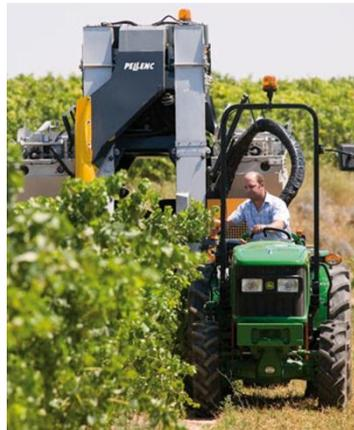
Figure 2 : Machine à Vendanger (MAV) tractée
