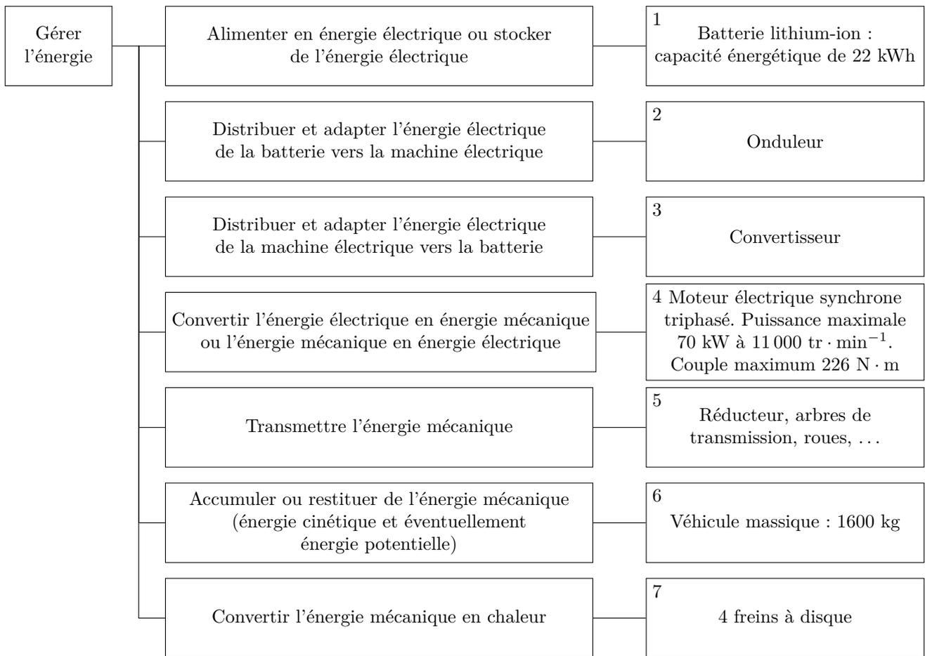
Figure 6 Diagramme FAST de la fonction « gérer l'énergie »
