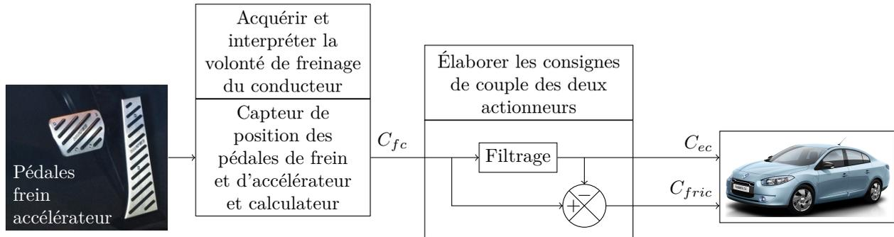
**Figure 9** Structure de commande à deux actionneurs
