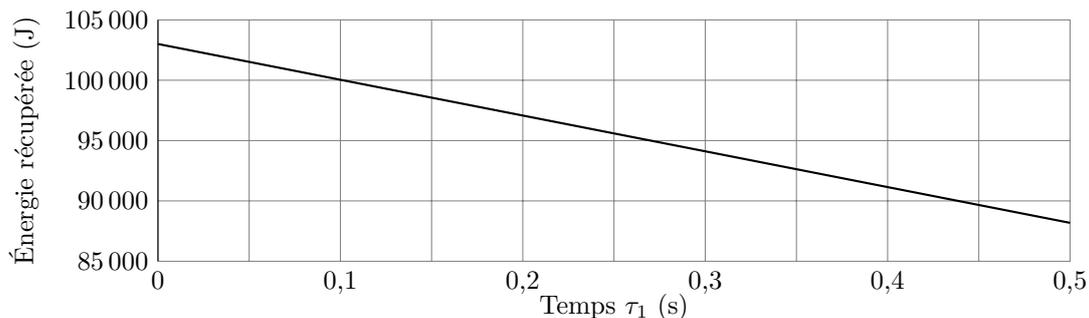
**Figure 10** Évolution de l'énergie récupérée en fonction de  $\tau_1$
