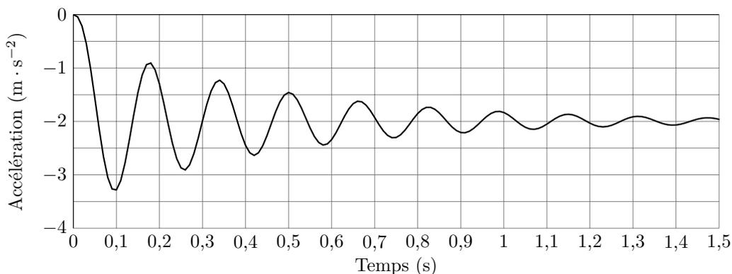
**Figure 13** Simulation de la décélération longitudinale du véhicule pour un modèle sans les freins à disque
