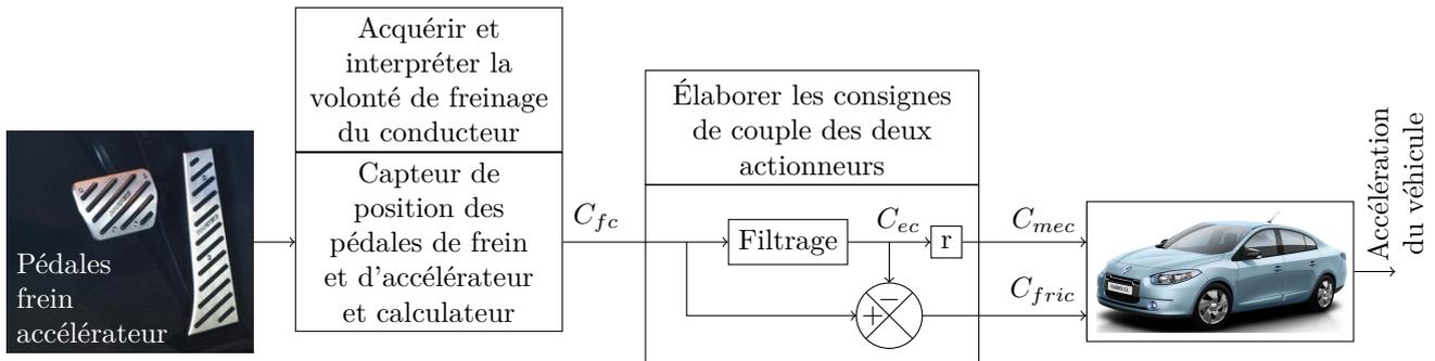
Figure 14 Structure de commande des deux actionneurs
