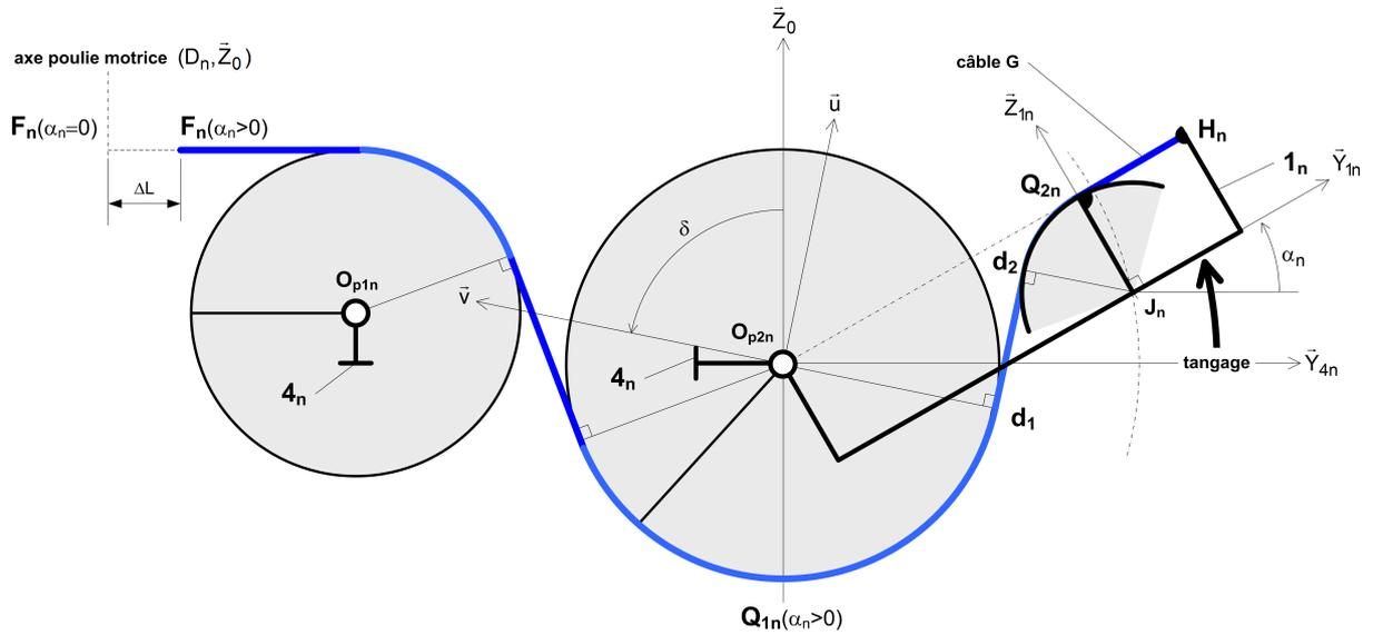
Figure A3, configuration du câble G pour le module porteur  $M_n$  en élévation (tangage  $\alpha_n > 0$ )
