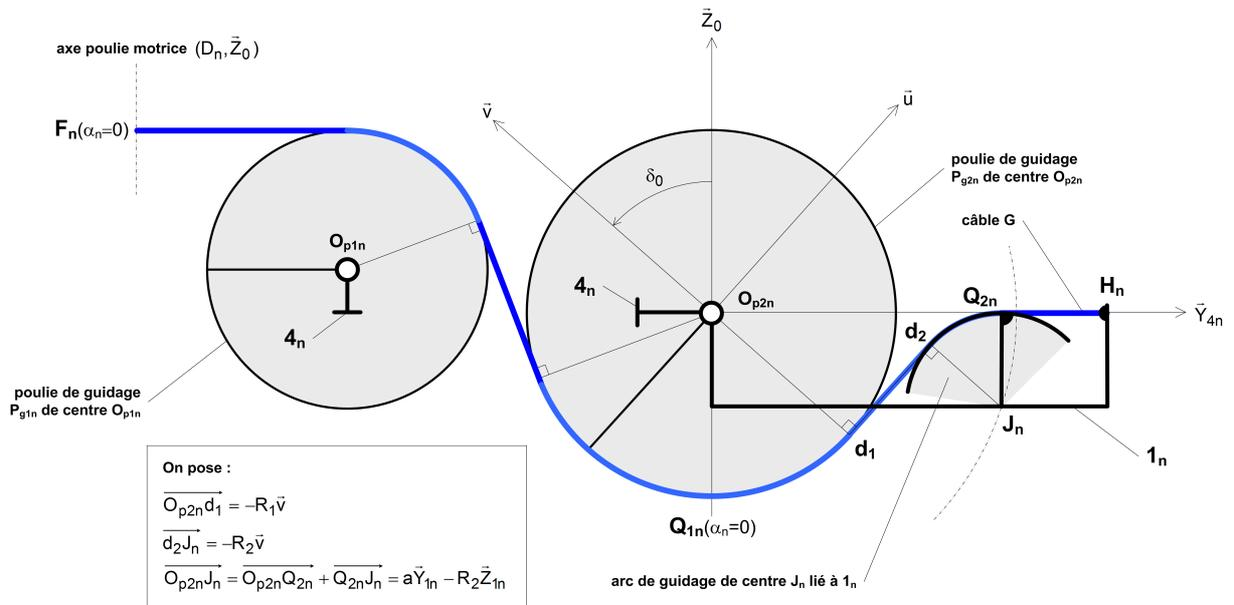
Figure A2, configuration du câble G pour le module porteur  $M_n$  horizontal (tangage  $\alpha_n = 0$ )
