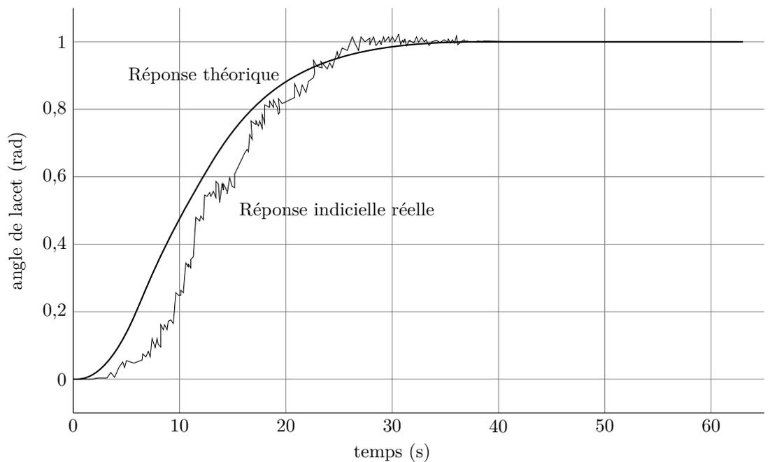
**Figure D** Réponse indicielle théorique et réelle
