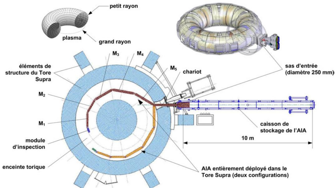
Figure 4 Déploiement du bras AIA dans l'enceinte du Tore Supra
