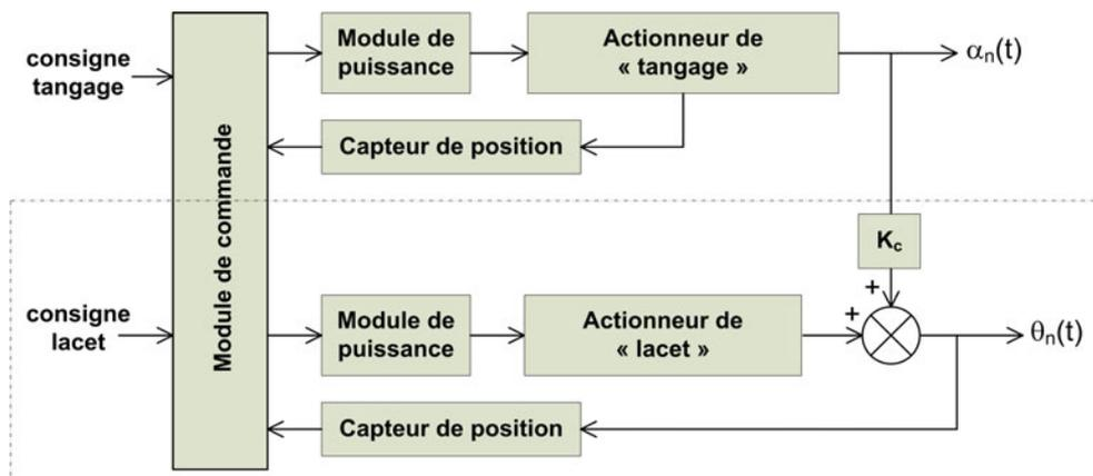
Figure 13 Détail de la commande du module porteur  $M_n$
