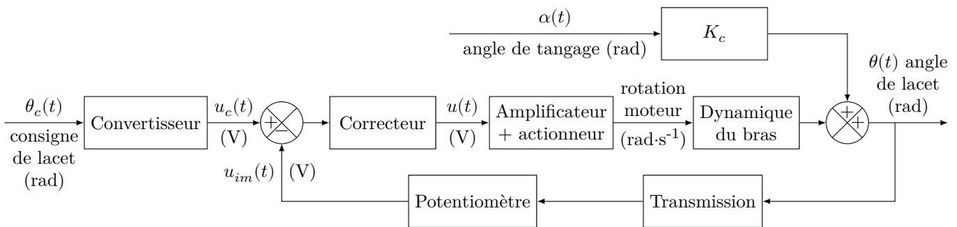
**Figure 16** Détail de la commande en position
