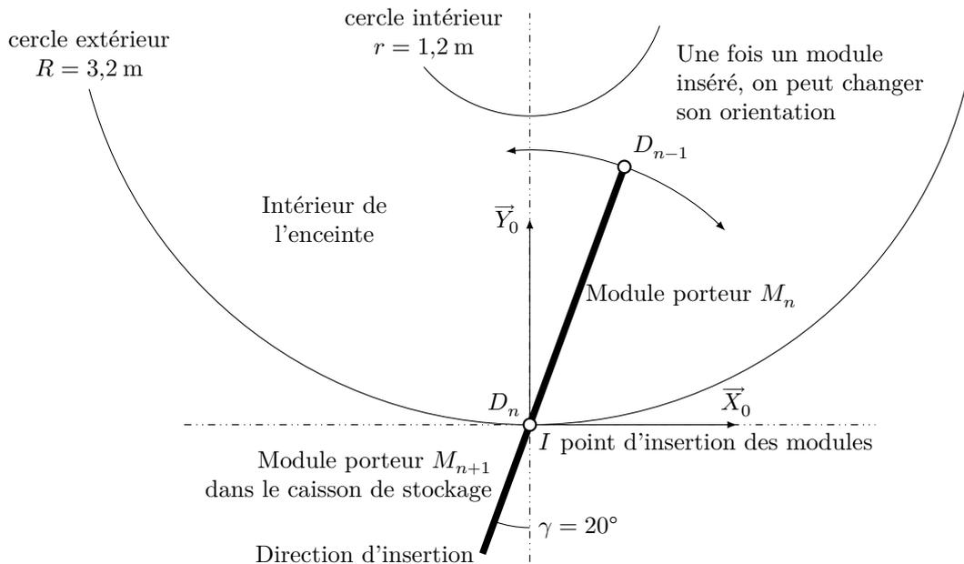
**Figure 9** Module porteur  $M_n$  en fin d'insertion
