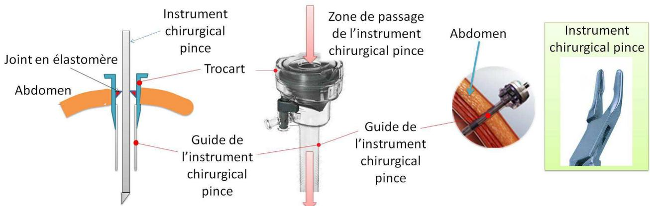
Figure 3 : Trocart et montage de l'instrument chirurgical pince
