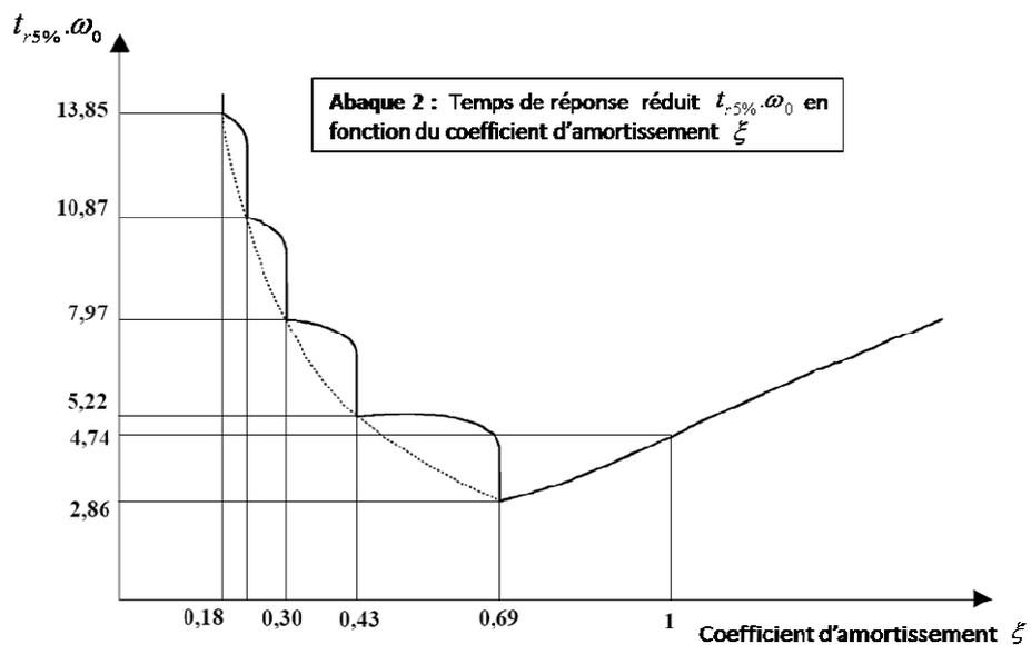
**Abaque 2 : Temps de réponse réduit  $t_{r,5\%} \cdot \omega_0$  en fonction du coefficient d'amortissement  $\xi$**
