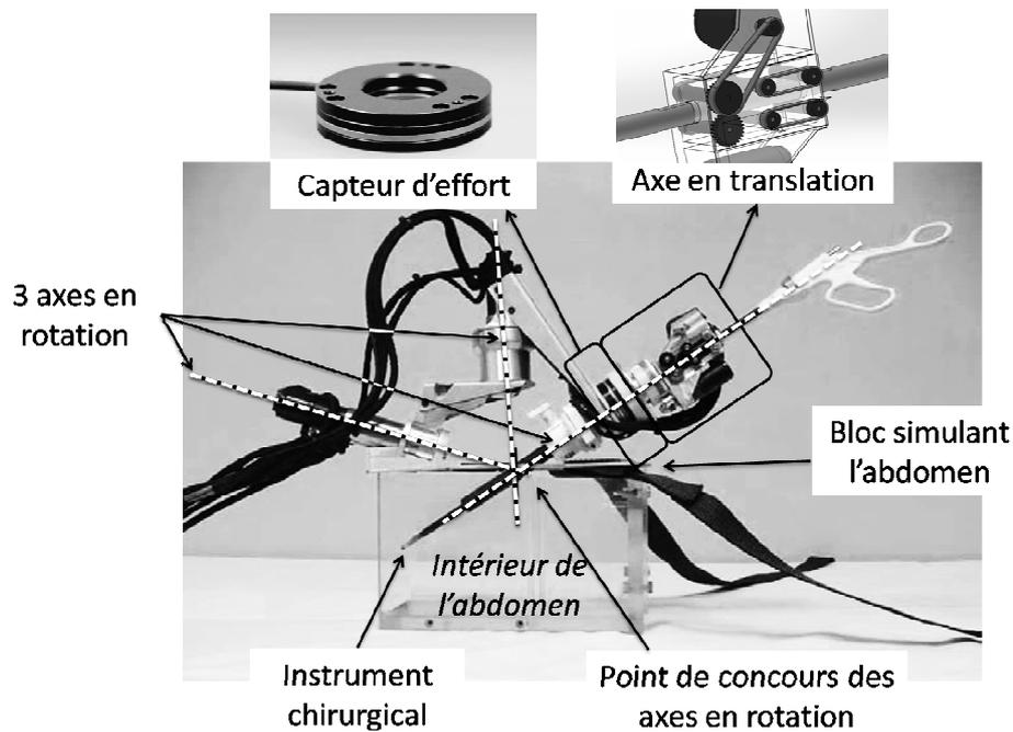
Figure 1 : Description simple du MC<sup>2</sup>E
