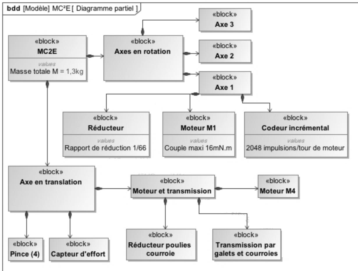
Figure 2 : Diagramme partiel de définition de blocs
