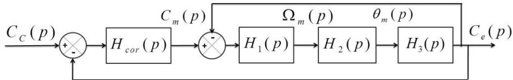
Figure 3 : Schéma-blocs de la régulation en effort
