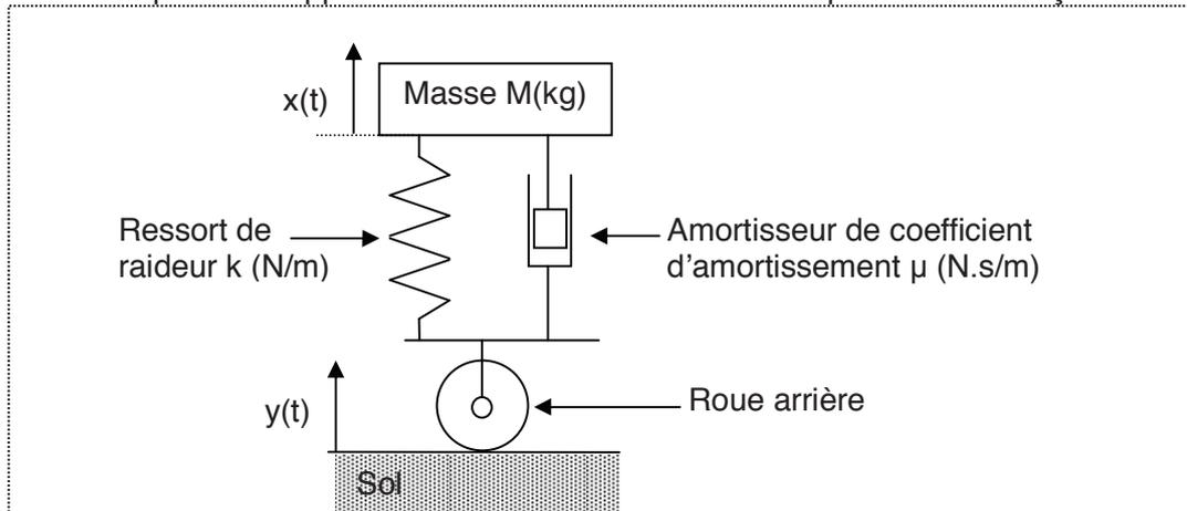
On suppose que l'origine de  $x(t)$  correspond à la situation où la moto roule avec un pilote dessus, en l'absence de défaut de la route.  $y(t)$  caractérise le profil de la route.
