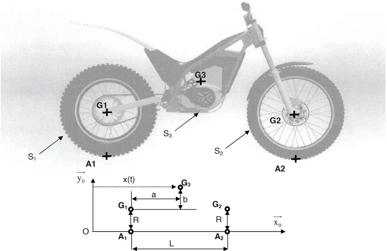
La moto est modélisée par 3 solides, la roue arrière  $S_1$ , la roue avant  $S_2$  et l'ensemble cadre-moteur-pilote  $S_3$ . Les roues sont en liaison avec le cadre par des liaisons pivot parfaites.
