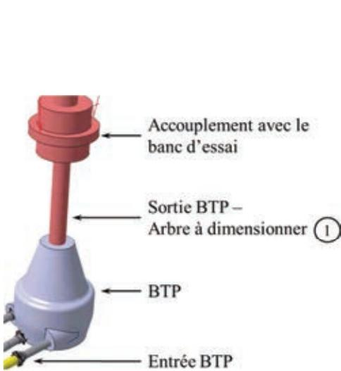
Figure 11 – Vue 3D de la BTP et du banc d'essai (système de mise en effort non représenté)
