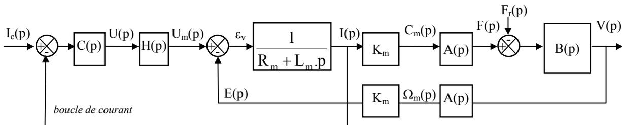
Avec :  $C(p) = R_m \left(1 + \frac{R_m}{L_m p}\right)$  le correcteur PI de la boucle de courant.
