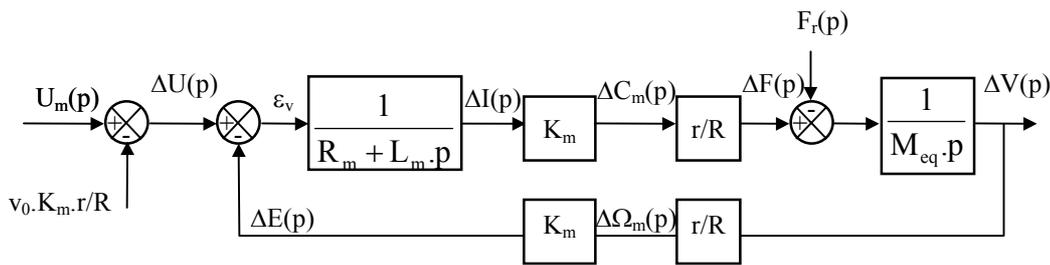
Dans le schéma bloc, on note pour une variable  $x$ ,  $\Delta x(t) = x(t) - x_0$  avec  $x_0 = x(t_0)$  et  $t_0$  l'instant où  $u_m(t)$  atteint  $U_{\max}$ . En particulier  $\Delta v(t) = v(t) - v_0$  avec  $v_0$  la vitesse atteinte à la fin de la phase à accélération constante.
