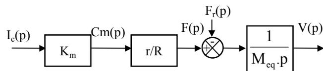
**Question 15** En utilisant le schéma bloc précédent, calculer  $V(p)$  en fonction de  $I_c(p)$  et  $F_r(p)$  puis en utilisant le tableau fourni en **Annexe 7**, déterminer l'équation de la vitesse  $v(t)$  du véhicule dans le cas où  $i_c(t)$  et  $F_r(t)$  sont des échelons respectivement d'amplitude  $I_0$  et  $F_0$ .
