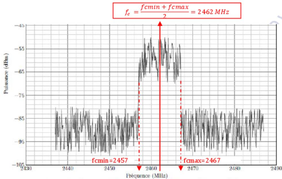
Figure A Relevé spectral de puissance du signal Wi-Fi reçu du Pro-form TDF
