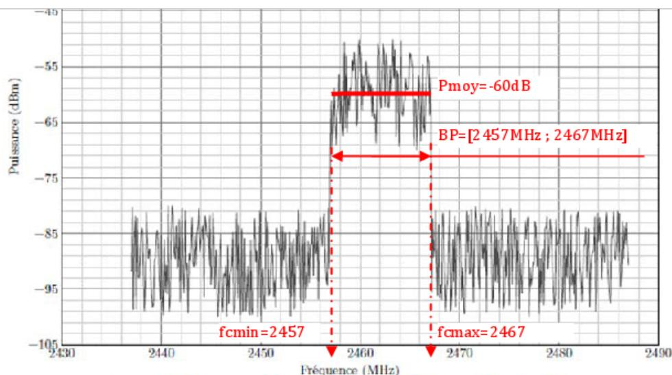
Figure A. Relevé spectral de puissance du signal Wi-Fi reçu du Pro-form TDF
