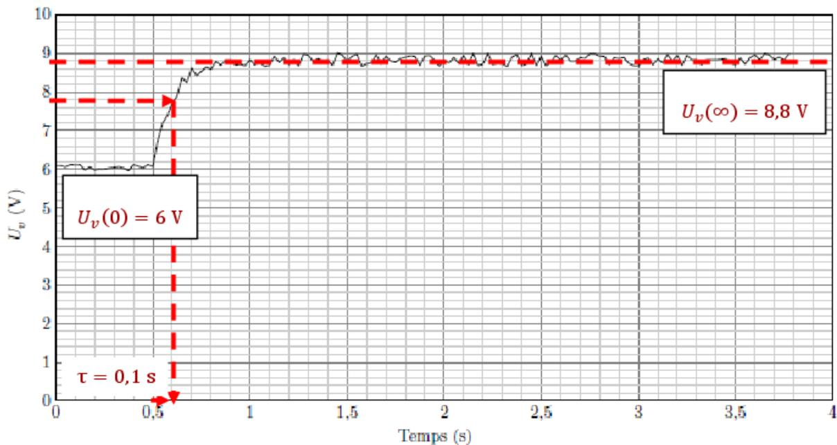
Figure B Réponse à l'essai
