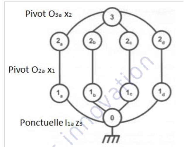
Les trois liaisons en série schématisées ci-dessus entre 0 et 3 sont équivalentes à une sphère plan de normale Z3.
