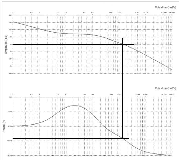
Une marge de phase de 50° correspond à un gain nul lorsque la phase de la FTBO vaut -130°. Pour avoir une marge de phase de 50°, il faut descendre la courbe de 20dB. Soit  $20 \log(K_i) = -20$ , et donc  $K_i = 0,1$ .
