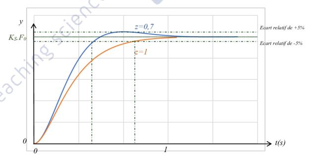
Les tracés précédents sont obtenus pour une valeur  $\omega_0$  fixée pour des temps de réponse conformes au cahier des charges.
