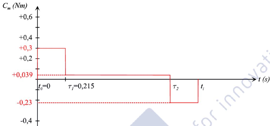
Pour déplacer un carton, le moteur doit fournir un couple maximal de 0,3 Nm et avoir une vitesse de rotation de  $\frac{203}{2\pi} \times 60 = 1938,5 \text{ tr.min}^{-1}$ . Ces valeurs sont compatibles avec les caractéristiques du moteur données en annexe 3 (couple maximal de 7,6 Nm et vitesse nominale de 3000  $\text{tr.min}^{-1}$ ) donc le moteur convient.
