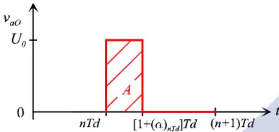
Pour calculer  $\langle v_{a0} \rangle_{nTd}$ , on utilise la méthode des aires.
