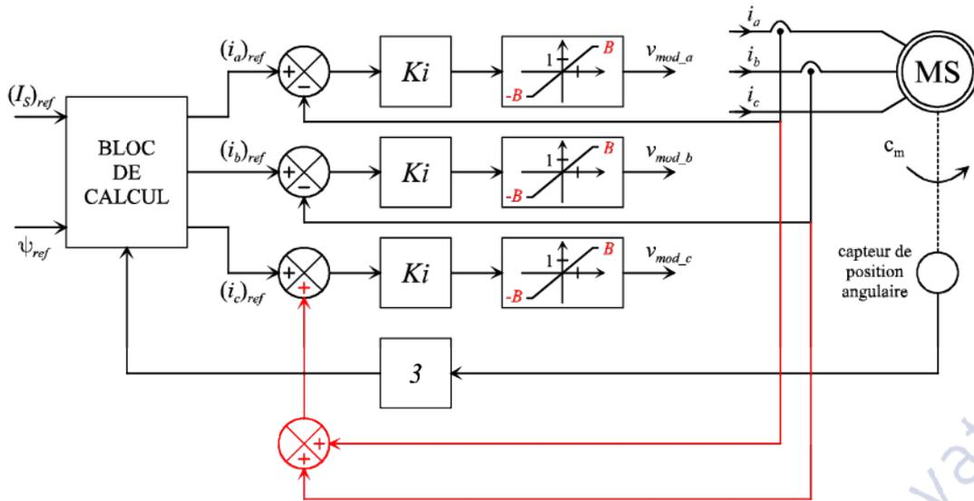
**Q38.** La phase instantanée des courants statoriques vaut  $\omega t$  avec  $\omega = p\Omega_s = p\Omega_m$  ( $p$  nombre de paires de pôles avec  $p = 3$ ). Donc  $\omega t = p\Omega_m t = p\theta_{m\acute{e}canique} = 3\theta_{m\acute{e}canique}$ , d'où la présence du bloc gain de valeur 3 sur la mesure de la position angulaire  $\theta_{m\acute{e}canique}$ .
