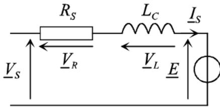
La loi des mailles permet d'écrire :  $\underline{V}_S = \underline{V}_R + \underline{V}_L + \underline{E}$
