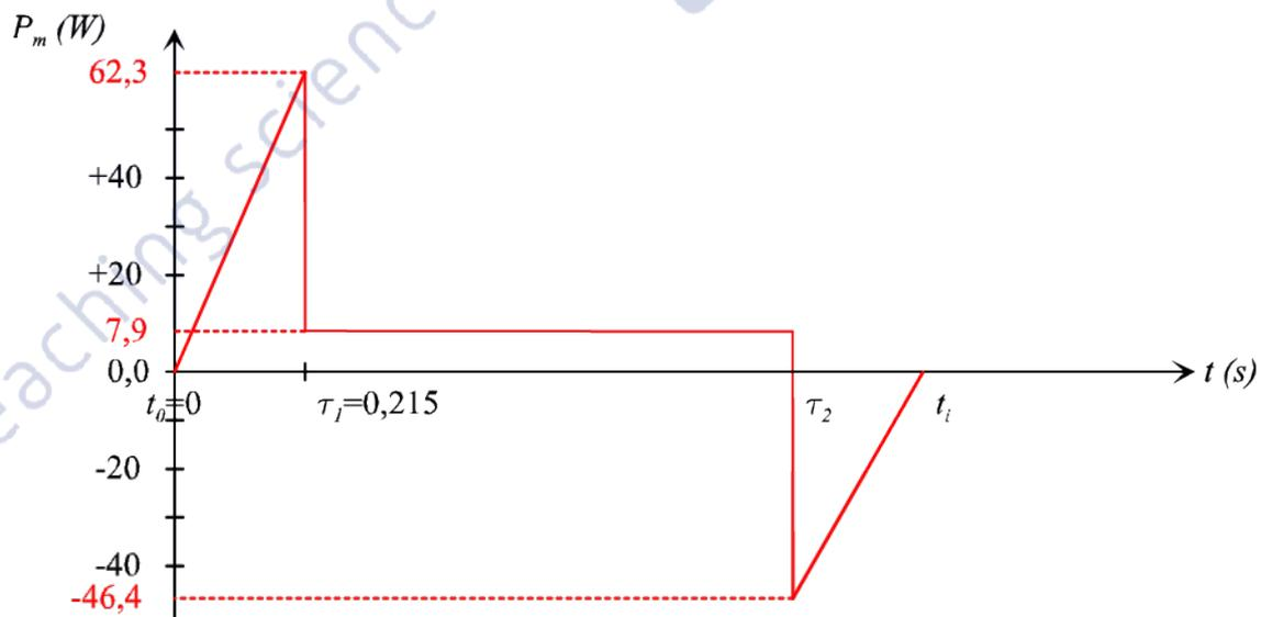
Q18. Entre les instants  $t_0$  et  $\tau_1$ , la machine synchrone fournit de la puissance mécanique ( $P_m > 0$ ), elle fonctionne donc en moteur et le convertisseur statique (modulateur) fonctionne en onduleur. Entre les instants  $\tau_2$  et  $t_i$ , la machine synchrone fournit de la puissance électrique ( $P_m < 0$ ), elle fonctionne donc en génératrice et le convertisseur statique (modulateur) fonctionne en redresseur.
