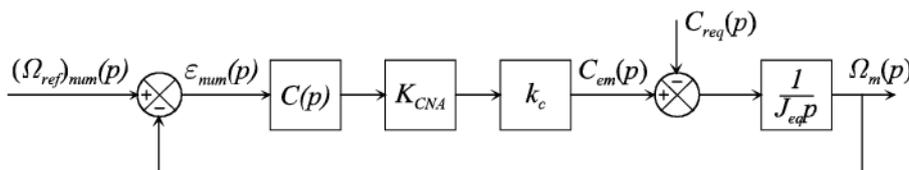
Nous avons  $\epsilon_{num}(p) = (\Omega_{ref})_{num}(p) - \Omega_m(p)$ ,  $\Omega_m(p) = \frac{1}{J_{eq}p} [C_{em}(p) - C_{req}(p)]$  et  $C_{em}(p) = C(p)K_{CNA}k_c\epsilon_{num}(p)$ .
