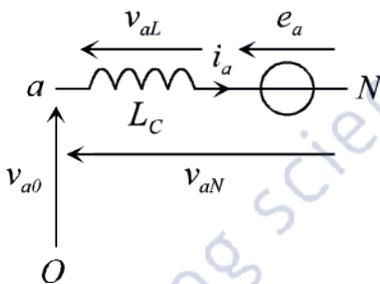
La loi des mailles permet d'écrire :  $v_{aN} = v_{aL} + e_a = L_C \frac{di_a}{dt} + e_a$ .
