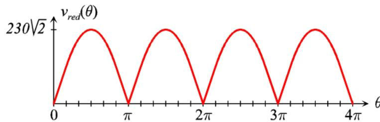
Par définition  $\langle v_{red} \rangle = \frac{1}{\pi} \int_0^\pi v_{red}(\theta) d\theta$ . Sur l'intervalle  $[0, \pi]$ , la tension  $v_{red}(\theta)$  est égale à la tension  $v_r(\theta)$  avec  $v_r(\theta) = V_r \sqrt{2} \sin(\theta)$ .
