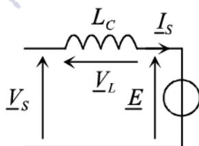
La loi des mailles permet d'écrire :  $\underline{V}_S = \underline{V}_L + \underline{E}$
