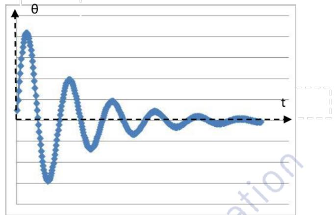
Lorsque la coagulation augmente, le coefficient de frottement augmente, le coefficient d'amortissement  $\zeta$  augmente aussi, les oscillations de la bille vont donc être de plus en plus faibles
