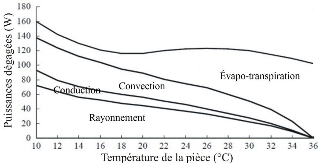
Figure 2 - Puissances thermiques dégagées par une personne
