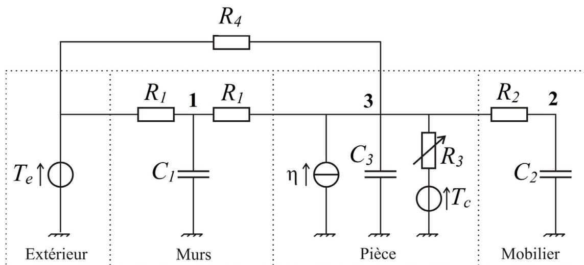
**Figure 4** - Schéma électrique équivalent de la pièce
