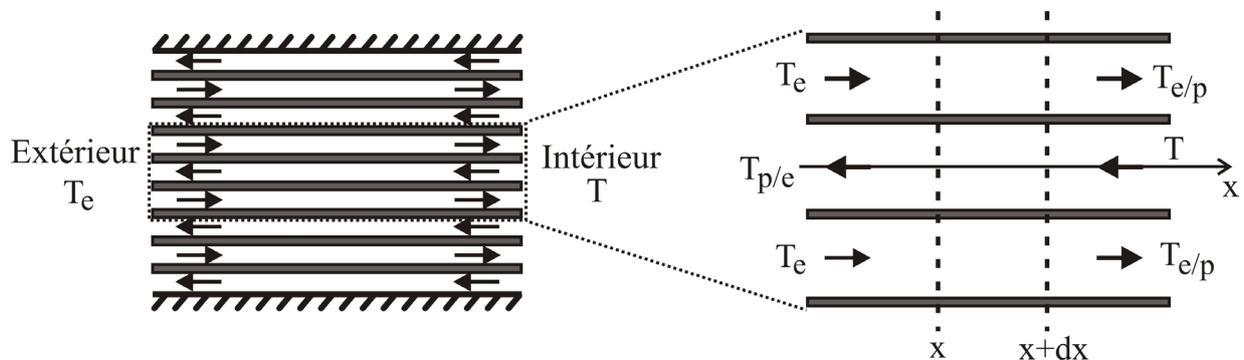
**Figure 3** - Schéma de l'échangeur à plaques étudié
