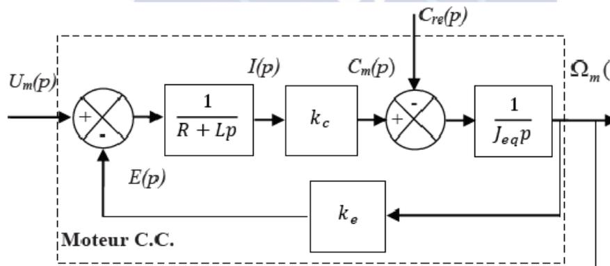
**Question 12** Déterminer les expressions littérales des fonctions de transfert en suivi de consigne  $H_1(p) = \frac{\Omega_m(p)}{U(p)} \Big|_{C_{re}(p)=0}$  et en régulation  $H_2(p) = \frac{\Omega_m(p)}{C_{re}(p)} \Big|_{U(p)=0}$ , sous forme canonique.
